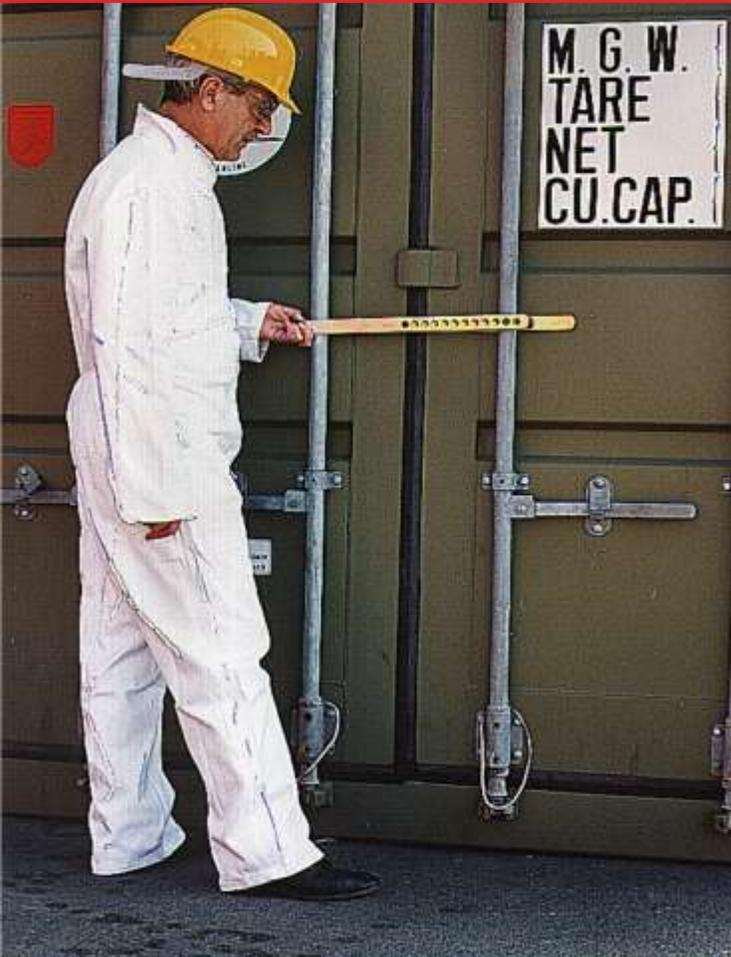
Hochsichere Barrierenplomben sind so konzipiert, dass sie eine erhebliche Barriere gegen den Containereintritt darstellen und direkt auf die zentralen Stangen des Containers wirken, um Ladungsdiebstahl zu verhindern.
