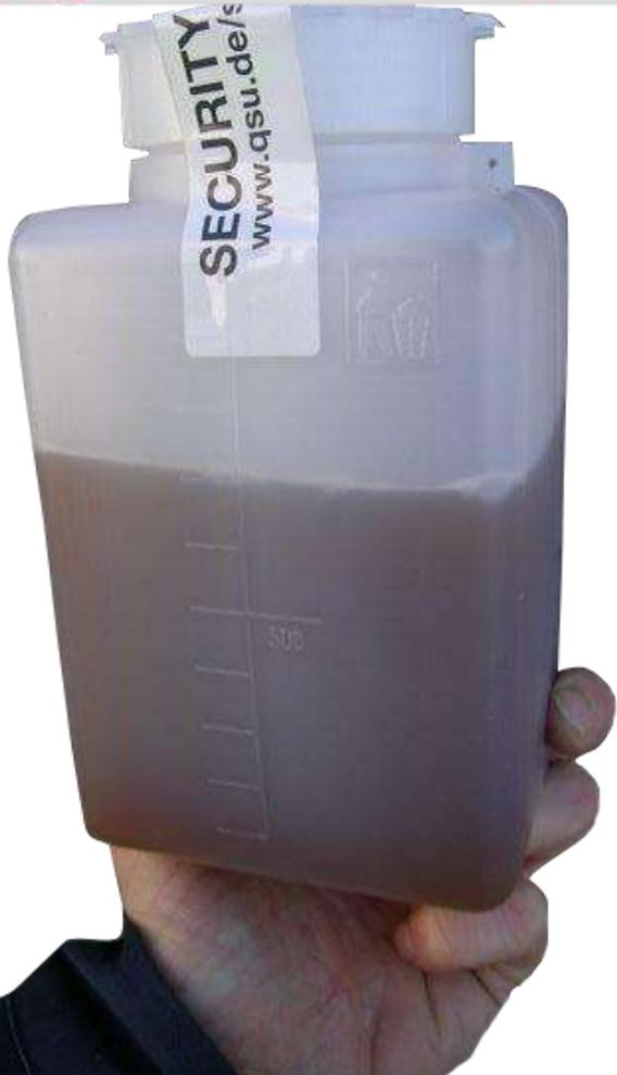
**WINDSHIELD TAG** von LeghornGroup: Siegetiketten high destructable mit RFID UHF Tag. Diese Lösung ist ideal für die Versiegelung von Probeflaschen. Wenn man versucht, die Etikette zu entfernen, zerstört sie sich. Diese Etikette erlaubt eine automatische Identifizierung jeder Probeflasche. Kann schnell und einfach verwendet werden und zeigt deutlich den Manipulationsversuch, da sie nicht wiederverwendbar ist.
