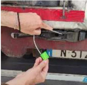
Führen Sie das Kabel in die Löcher ein, die versiegelt werden müssen.
