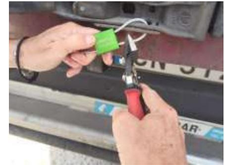
Um die Plombe zu entfernen, muss sie mit einer speziellen Zange geschnitten werden.
