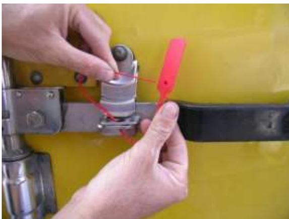
Setzen Sie das Plombenende im hinteren Loch des Plombenkopfes ein.
